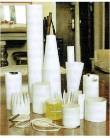
Da bi zagotovili kolikor toliko prožno zapiranje kontejnerja z vodo, v valj najprej vstavimo penasto blazinico (4), ki jo izdelamo iz sedmih lističev penaste gume debeline 1,5 mm. Kontejner (sklop 1) zapre-
