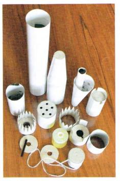
kete. To so glava z adapterjem (A), trup modela (B) in stožčasto zožen repni del (C) s stabilizatorji ter padalo (D) kot posebna enota, namenjena za varen pristanek modela.
